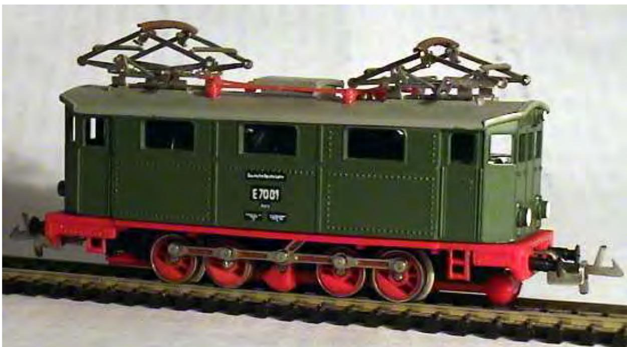
Непосредственный привод от двигателя получала лишь одна колесная пара, остальные приводились в действие посредством сцепных дышел, тем самым обеспечивалось практически полное соответствие кинематической схемы модели прототипу. Стоит отметить, что на ведущей оси была посажена косозубая шестерня значительно большего диаметра, нежели на всех иных аналогичных деталях других
